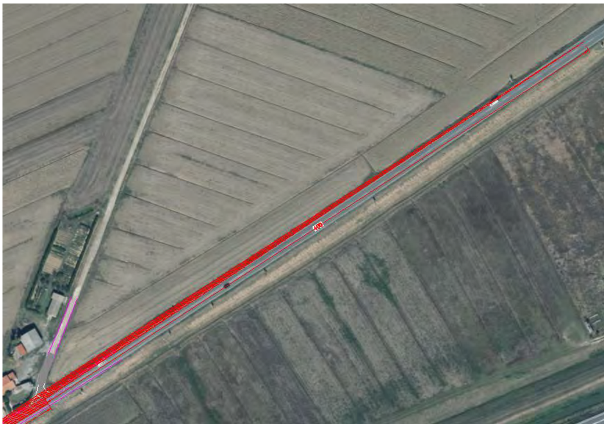
Fig. 3.8- Triangolo di visibilità in direzione Navacchio (V85 102 km/h) – estratto allegato
