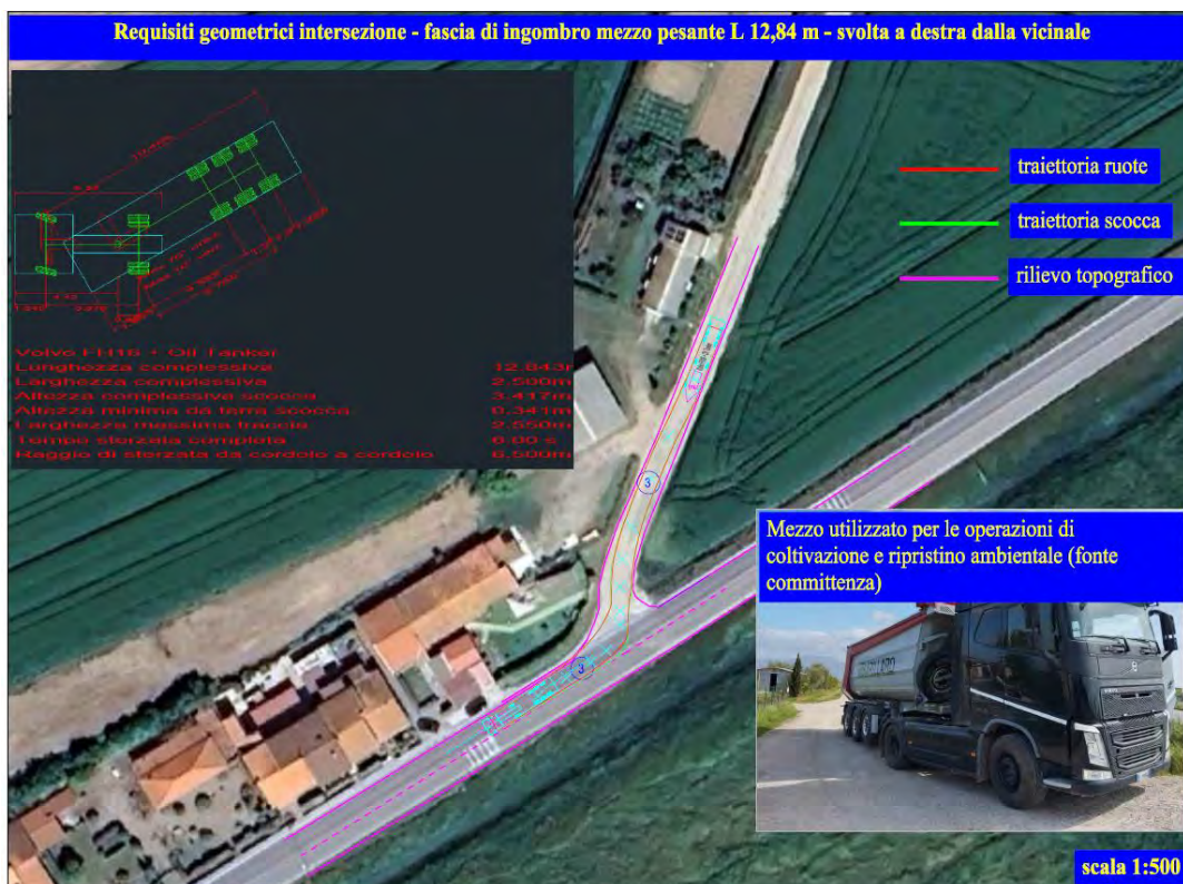
Fig. 3.2- Schemi grafici e calcolo dei raggi di ingombro delle traiettorie – estratto allegato
