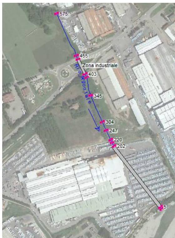
Figura 2-8 – Estratto della geometria su modello matematico a partire dal rilievo topografico, Rio Argontale
