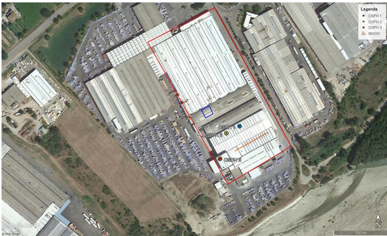
Fig. 3.1 – dettaglio ubicazioni indagini. La linea arancione rappresenta lo stendimento masw realizzato per la misurazione della V_{s30} .
