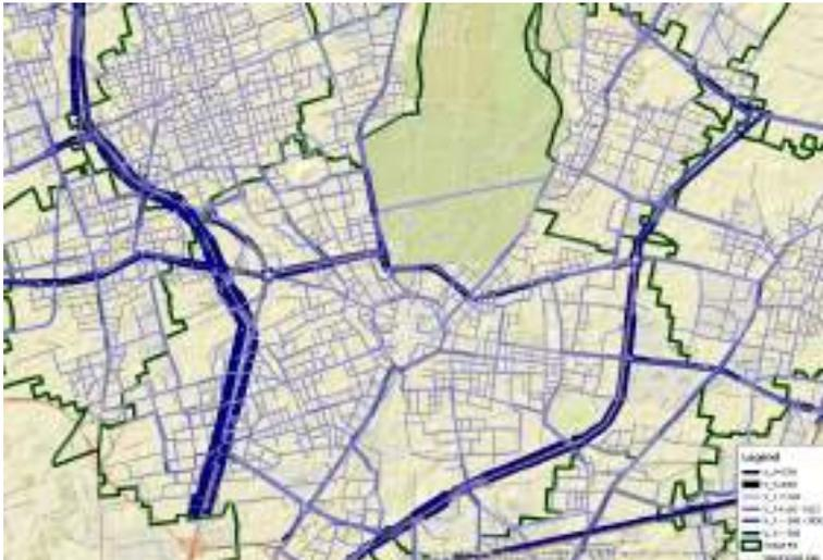
Il risultato evidenziato dalla figura a lato definisce, per ciascun arco della rete, il flusso di traffico (espresso in veicoli equivalenti) dell'ora di punta (07:30-08:30). I valori dei flussi sono riportati in destra e in sinistra per gli archi a doppio senso di marcia. Nel caso di viabilità a senso unico l'unico valore presente riporta i veicoli equivalenti che attraversano l'arco specifico nell'ora di punta.
