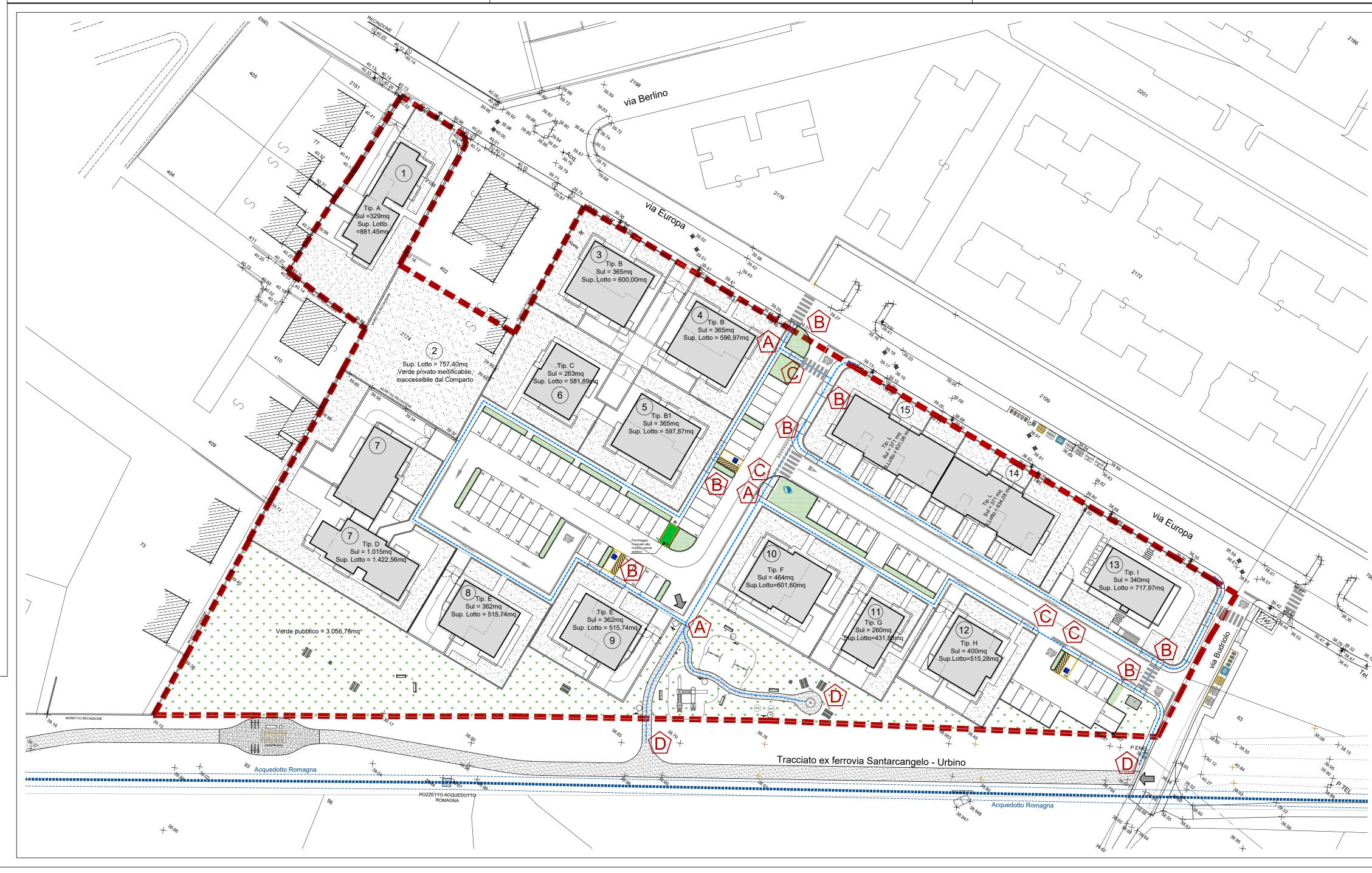
SCHEMI DI SEGNALAZIONE PERCORSI TATTILI, TRAMITE CODICI LOGES, PER PERSONE IPOVEDENTI, ai sensi del D.P.R. 503/1996 e D.M. 236/1989
